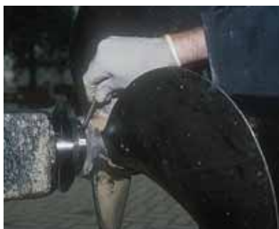
Slik monteres Prop Protector på akselen.
